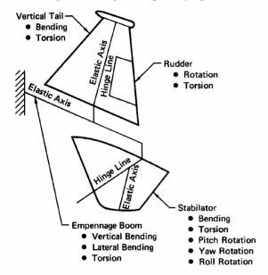
Fig. 9 F-15 empennage arrangement.
